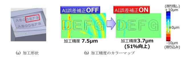
図 3-2 CNC 切削加工機における評価結果
